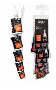
Existe en versions résistance faible, moyenne et forte. Résine spécialement conçue pour le blocage des parties filetées. Evite le desserrage accidentel dû aux vi brations, et rend inutile l'utilisation de rondelles. Efficace pour un ieu inférieur à 0,3 mm. Manipulable après 30 mn, sec après 14 heures. Résiste à des températures comprises entre -55 °C et +150 °C.
